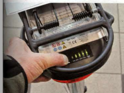
La jauge d'autonomie est également visible à l'arrière de la batterie sur le modèle Waysical.
